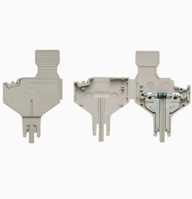
La fiche avec composant est utilisée pour intégrer des composants électriques dans un bloc de jonction sectionnable. Après avoir soudé les composants électroniques, le mâle peut être intégré dans la zone de déconnexion de nos blocs de jonction sectionnable et change ainsi le bloc de jonction sectionnable en bloc de jonction modulaire avec composants électroniques intégrés.
