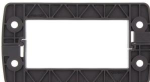
Le cadre, issu d'une pièce unique, est simple et rapide à monter. Il est composé de plastique renforcé à la fibre de verre aux dimensions stables. Le joint en mousse captive garantit une étanchéité se niveau IP66 selon la norme EN 60529, même sur les surfaces peintes ou brutes.
