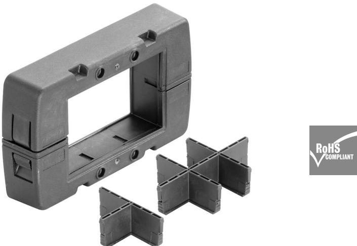
Le cadre, issu d'une pièce unique, est simple et rapide à monter. Il est composé de plastique renforcé à la fibre de verre aux dimensions stables. Le joint en mousse captive garantit une étanchéité se niveau IP66 selon la norme EN 60529, même sur les surfaces peintes ou brutes.
