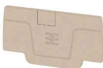
Les flasques de fermeture sont placées à l'extrémité ouverte du bornier, avant l'équerre de blocage. L'utilisation des flasques de fermeture permet de conserver les caractéristiques des blocs de jonction comme par exemple la tension nominale. On évite ainsi le contact avec les pièces sous tension et le dernier bloc de jonction est protégé contre l'accès des doigts .
