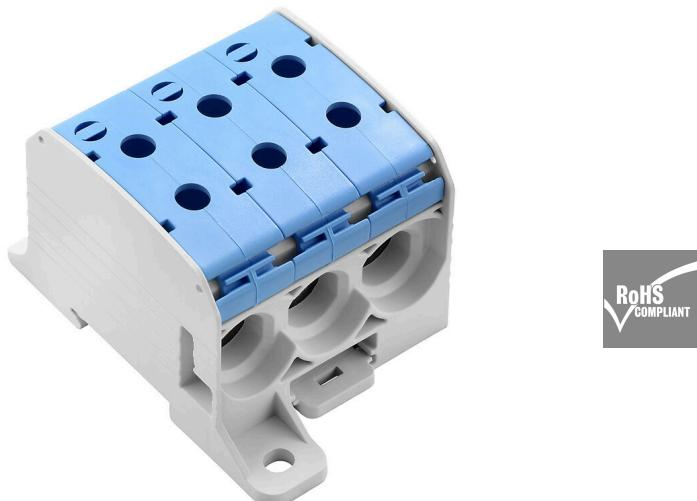
Les blocs de jonction d'alimentation électrique Klippon® Connect WPD permettent une installation facile et sûre des conducteurs en aluminium et en cuivre avec un faible encombrement. Une alimentation auxiliaire ou un raccordement de surveillance peut être utilisé(e) en option. Les clients peuvent utiliser les blocs de jonction d'alimentation électrique WPD indépendamment du matériel du conducteur. Ils peuvent être montés directement ou sur le rail DIN TS35.
