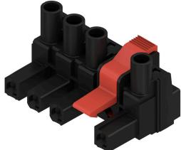
Connecteur femelle à 180° au pas de 7,62 pour réseaux IT. Satisfait les exigences de UL1059 600 V classe C. Associé au connecteur mâle SL 7.62 IT.... Avec contact principal. Satisfait les exigences étendues de 5,5 mm de protection de contact pour réseaux IT, conformément à CEI 61800-5-1 pour 400 V avec la terre. La bride centrale à verrouillage qui peut optionnellement être vissée réduit l'espace nécessaire de la largeur d'un pas par rapport aux solutions conventionnelles.
