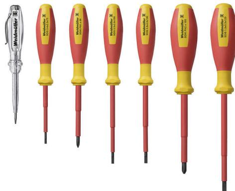
Tournevis isolés VDE Weidmüller SoftFinish electric pour intervention sur pièces sous tension jusqu'à 1000 V AC et 1500 V DC, DIN EN 60900, IEC 900. Sécurité contrôlée "GS", testée unitairement. Lame en alliage chrome-vanadium-molybdène-acier de haute qualité, entièrement dure, brunie.
