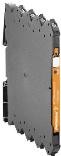
Le convertisseur de mesure de fréquence universel configurable par logiciel sépare et transforme les signaux d'entrée (fréquence, Namur, NPN, PNP, Tacho, TTL et SO) en signal de sortie standard analogique actif. L'alimentation électrique est séparée galvaniquement de l'entrée et de la sortie (séparation à 3 voies) et est effectuée par un câblage direct. Le modèle ACT20M-FRQ-AO-S peut être alimenté via le bus de rail de support Weidmüller
