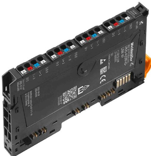
Modules de communication et de compteur numériques 100/500 kHz ; résolution du compteur 32 bits ; diagnostic individuel des voies Les codeurs incrémentaux et absolus sont désormais des éléments incontournables des systèmes automatisés.
