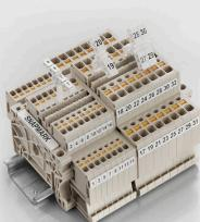
SnapMark - ce support de repérage a été développé spécialement pour les blocs de jonction double étage IDK 1.5N série I. Grâce au mécanisme articulé basculant, les connexions transversales peuvent être montées et enlevées sans problème. Il peut accueillir quatre repères DEK 5 ou deux repères de blocs de jonction WS 10/5 Middle.
