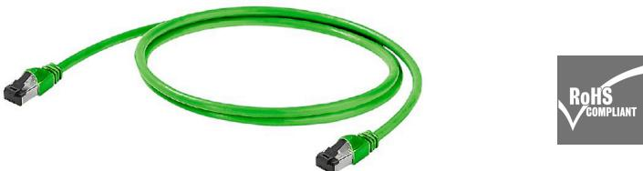
Cordons confectionnés avec 2x RJ45, adaptés aux applications de mesure intelligentes, couleurs différentes selon DIN VDE 0603-100. Mâles courts et câbles avec petit rayon de courbure pour les espaces restreints, boîtier du connecteur avec isolation circonférentielle permettent la classe de protection IP30 en état accouplé.
