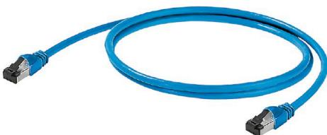
Cordons confectionnés avec 2x RJ45, adaptés aux applications de mesure intelligentes, couleurs différentes selon DIN VDE 0603-100. Mâles courts et câbles avec petit rayon de courbure pour les espaces restreints, boîtier du connecteur avec isolation circonférentielle permettent la classe de protection IP30 en état accouplé.
