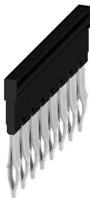
La distribution ou la multiplication d'un potentiel aux blocs de jonction adjacents est réalisée par une connexion transversale. Un effort supplémentaire de câblage peut être facilement évité. Même si les pôles sont cassés, la fiabilité des contacts dans les blocs de jonction est toujours assurée. Notre portefeuille offre des systèmes de connexion transversale enfichables et vissables pour les blocs de jonction modulaires.
