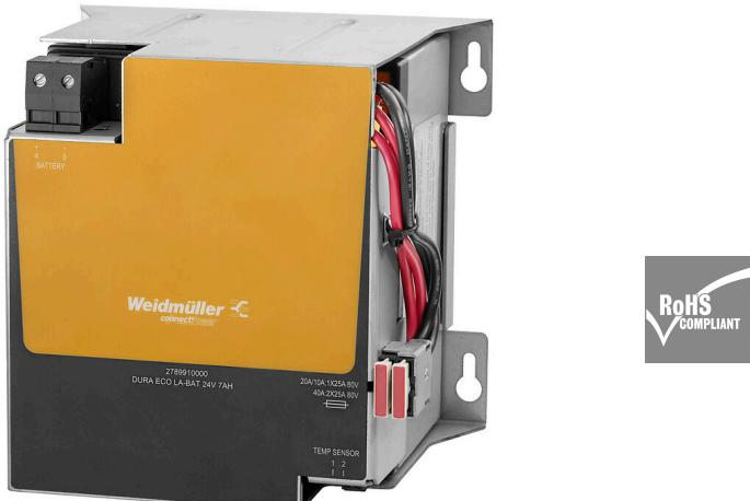
Les 5 modules de batterie avec des capacités de 1,2 Ah à 17 Ah peuvent alimenter jusqu'à 40 A pendant 30 minutes ou 1 A pendant 30 heures et sont entièrement compatibles avec les alimentations sauvegardées DC CP DC UPS 24 V 20 A/10 A et CP DC UPS 24 V 40 A. Et bien sûr, les séries DURAeco sont une solution flexible et facile d'utilisation dans une conception rentable.
