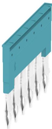
La distribution ou la multiplication d'un potentiel aux blocs de jonction adjacents est réalisée par une connexion transversale. Un effort supplémentaire de câblage peut être facilement évité. Même si les pôles sont cassés, la fiabilité des contacts dans les blocs de jonction est toujours assurée. Notre portefeuille offre des systèmes de connexion transversale enfichables et vissables pour les blocs de jonction modulaires.
