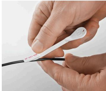
Les repères de câbles et de conducteurs SlimFix permettent de gagner de la place. Les repères peuvent être installés même après le câblage de l'installation. Ils sont réalisés dans un matériau exempt d'halogène, avec classe d'inflammabilité V0/V2. SlimFix est un type de repère reconnu et approuvé dans le domaine du transport. L'outil SF permet une mise en place facile, même lorsqu'il s'agit de petits repères.
