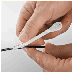
Les repères de câbles et de conducteurs SlimFix permettent de gagner de la place. Les repères peuvent être installés même après le câblage de l'installation. Ils sont réalisés dans un matériau exempt d'halogène, avec classe d'inflammabilité V0/V2. SlimFix est un type de repère reconnu et approuvé dans le domaine du transport. L'outil SF permet une mise en place facile, même lorsqu'il s'agit de petits repères.
