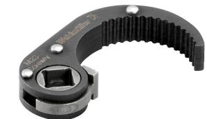
Les accessoires Screwty® sont indiqués pour les connecteurs débrochables ronds M23 à équiper et moulés, avec une dimension extérieure du moletage de  $26,2 \pm 0,3$  mm. Le couple de raccordement est de 2-2,5 Nm.
