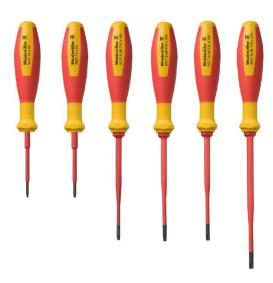
Tournevis isolés VDE Weidmüller SoftFinish electric pour intervention sur pièces sous tension jusqu'à 1000 V AC et 1500 V DC, DIN EN 60900, IEC 900. Sécurité contrôlée "GS", testée unitairement. Lame en alliage chrome-vanadium-molybdène-acier de haute qualité, entièrement durcie, brunie.
