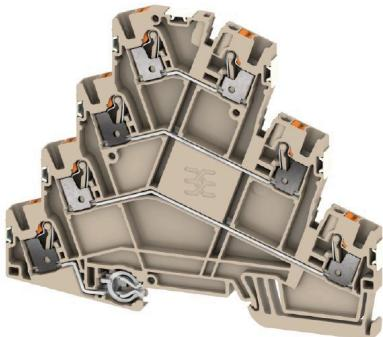
L'alimentation en énergie, signaux et données est une exigence classique en ingénierie électrique et en réalisation d'armoires. Le matériau isolant, la technique de raccordement et la conception des blocs de jonction sont les caractéristiques distinctives. Un bloc de jonction traversant est adapté pour relier et/ou raccorder un ou plusieurs conducteurs. Ils peuvent avoir un ou plusieurs niveaux de raccordement qui ont le même potentiel ou qui sont isolés les uns par rapport aux autres.
