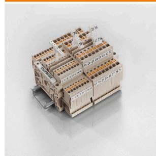
SnapMark - ce support de repérage a été développé spécialement pour les blocs de jonction double étage IDK 1.5N série I. Grâce au mécanisme articulé basculant, les connexions transversales peuvent être montées et enlevées sans problème. Il peut accueillir quatre repères DEK 5 ou deux repères de blocs de jonction WS 10/5 Middle.
