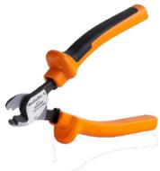
Outils à couper pour conducteurs jusqu'à 8 mm, 12 mm, 14 mm et 22 mm de diamètre extérieur. La géométrie de coupe spéciale assure une coupe nette et sans écrasement des conducteurs en cuivre et aluminium avec un effort physique minimum. En outre, les outils de coupe (KT 8 à KT 22) sont munis d'une protection isolante testée VDE et GS jusqu'à 1 000 V, conformément aux normes EN/CEI 60900.
