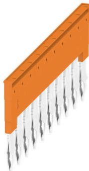
La distribution ou la multiplication d'un potentiel aux blocs de jonction adjacents est réalisée par une connexion transversale. Un effort supplémentaire de câblage peut être facilement évité. Même si les pôles sont cassés, la fiabilité des contacts dans les blocs de jonction est toujours assurée. Notre portefeuille offre des systèmes de connexion transversale enfichables et vissables pour les blocs de jonction modulaires.
