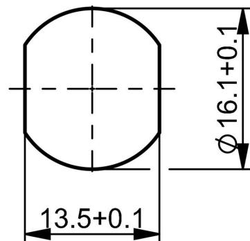
A trou de passage avec protection contre la torsion
