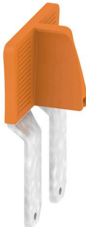
La distribution ou la multiplication d'un potentiel aux blocs de jonction adjacents est réalisée par une connexion transversale. Un effort supplémentaire de câblage peut être facilement évité. Même si les pôles sont cassés, la fiabilité des contacts dans les blocs de jonction est toujours assurée. Notre portefeuille offre des systèmes de connexion transversale enfichables et vissables pour les blocs de jonction modulaires.
