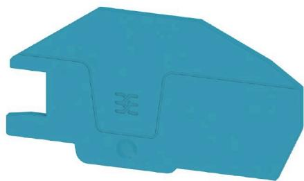
Les flasques de fermeture sont placées à l'extrême ouverte du bornier, avant l'équerre de blocage. L'utilisation des flasques de fermeture permet de conserver les caractéristiques des blocs de jonction comme par exemple la tension nominale. On évite ainsi le contact avec les pièces sous tension et le dernier bloc de jonction est protégé contre l'accès des doigts .
