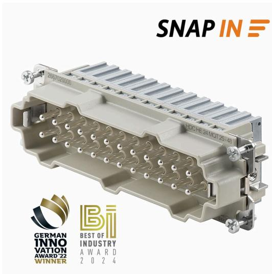
Avec le raccordement SNAP IN, la zone de raccordement du conducteur est déjà ouverte et il suffit d'y insérer le connecteur dénudé. Dans la position finale, le mécanisme de serrage breveté se referme automatiquement. Il en résulte un raccordement sûr, permanent et résistant aux vibrations qui ne nécessite pratiquement aucune maintenance. Weidmüller est le premier et le seul fabricant à proposer ce système de raccordement innovant.
