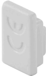
Les capuchons d'extrémité et les protections assurent les lignes de fuite requises dans le système même après que les barres d'autobus ont été coupées à la longueur ou dans le cas de contacts autonomes, et la protection des doigts de garantie conformément à la norme DIN EN 50274.
