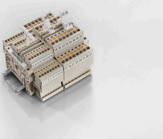
SnapMark - ce support de repérage a été développé spécialement pour les blocs de jonction double étage IDK 1.5N série I. Grâce au mécanisme articulé basculant, les connexions transversales peuvent être montées et enlevées sans problème. Il peut accueillir quatre repères DEK 5 ou deux repères de blocs de jonction WS 10/5 Middle.
