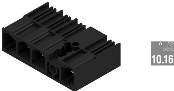
Connecteur mâle avec bride de fixation centrale au pas de 10,16 pour les systèmes 400-V IT selon CEI 61800-5-1.
