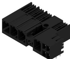
Connecteur mâle combiné à 90° avec contacts de signaux et de puissance avec raccordement PUSH IN incluant une bride centrale à verrouillage et (en option), un raccordement de blindage enfichable, au pas de 7,62.
