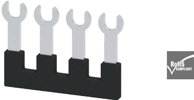
La distribution ou la multiplication d'un potentiel aux blocs de jonction adjacents est réalisée par une connexion transversale. Un effort supplémentaire de câblage peut être facilement évité. Même si les pôles sont cassés, la fiabilité des contacts dans les blocs de jonction est toujours assurée. Notre portefeuille offre des systèmes de connexion transversale enfichables et vissables pour les blocs de jonction modulaires.
