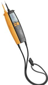
La tâche principale d'un testeur de tension est de vérifier l'absence de tension. Un testeur de tension bipolaire est le seul instrument de test qui remplit toutes les exigences en matière de sécurité du travail.
