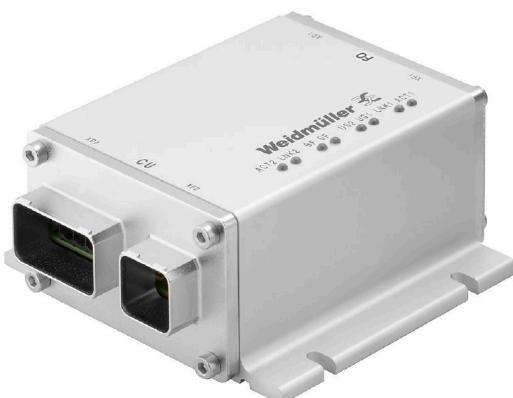
Convertisseur de média FreeCon Active PROFINET, avec fonction de diagnostic, pour connecteur enfichable Push-Pull Var. 14, selon CEI 61076-3-117 avec RJ45 et SC-RJ POF selon CEI 61754-24 et PushPull Power selon les spécifications PROFINET.
