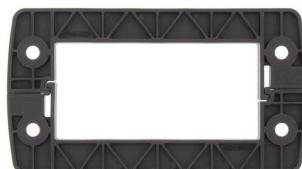
Le cadre, issu d'une pièce unique, est simple et rapide à monter. Il est composé de plastique renforcé à la fibre de verre aux dimensions stables. Le joint en mousse captive garantit une étanchéité au niveau IP66 selon la norme EN 60529, même sur les surfaces peintes ou brutes.
