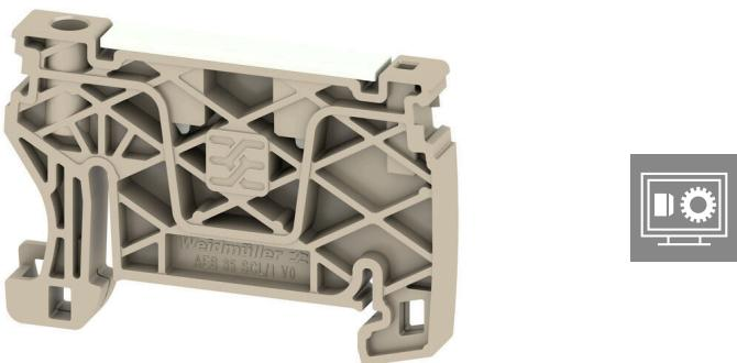
Pour maintenir correctement les blocs de jonction et éviter qu'ils glissent, Weidmüller propose des équerres de blocage. Il existe des versions vissées et non vissées. Il est possible de placer des repères sur les équerres de blocage ainsi que des repères de groupe et il est possible de mettre des fiches de contrôle.
