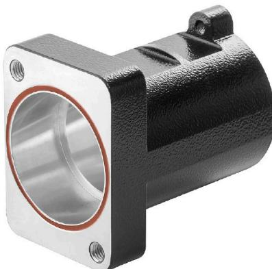
Le boîtier de protection est fabriqué à partir d'aluminium résistant à l'eau de mer, par coulage sous pression.
