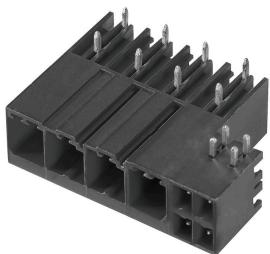
Connecteur mâle combiné à 270° avec contacts de signaux et de puissance incluant une bride centrale à verrouillage, au pas de 7,62.
