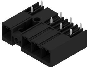
Connecteur mâle à 270° avec bride centrale, au pas de 7,62. Satisfait les exigences de CEI 61800-5-1 et permet l'homologation UL selon UL840 600 V. Sans connecteur femelle, la face d'enfichage garantit une protection de contact d'au moins 3 mm lors d'une pression du doigt de 20 N.
