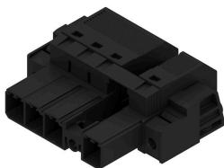
Connecteur mâle inversé à 180° avec raccordement PUSH IN pour câblage de terrain 6 mm<sup>2</sup> au pas de 7,62, réalisant une « version à trois brides » pour passage boîtier. Convient aux boîtiers dont l'épaisseur de paroi ne dépasse pas 16 mm. En plus, convient idéalement aux solutions de protection des doigts pour tensions inverses. Satisfait les exigences des normes UL1059 600 V classe C et CEI 61800-5-1.
