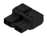
Connecteur mâle inversé à 180° sans tension inverse, avec raccordement PUSH IN pour câblage de terrain. Avec bride centrale à verrouillage automatique pour câblage de terrain 6 mm² au pas de 7,62.
