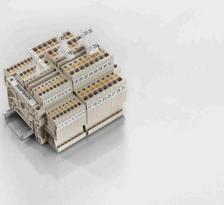
SnapMark - ce support de repérage a été développé spécialement pour les blocs de jonction double étage IDK 1.5N série I. Grâce au mécanisme articulé basculant, les connexions transversales peuvent être montées et enlevées sans problème. Il peut accueillir quatre repères DEK 5 ou deux repères de blocs de jonction WS 10/5 Middle.
