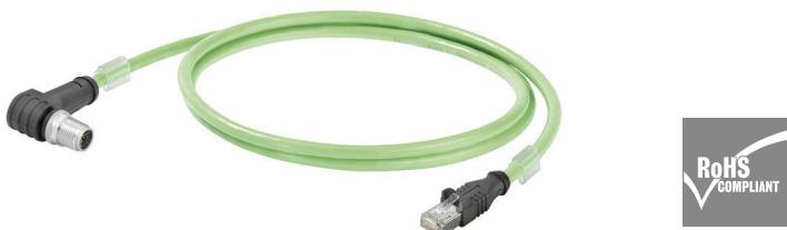
Câbles IE confectionnés pour applications EtherNet/IP avec connecteur débrochable, type M12 X, cat. 6A, selon CEI 61076-2-109 et RJ45 connecteur débrochable pour applications 10 GBit/s
