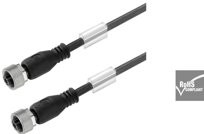
Les câbles capteurs externes / actionneurs sont utilisés pour câbler capteurs et actionneurs ainsi que pour transmettre des données ou du courant dans de nombreuses applications. Le câble surmoulé offre dès départ usine un raccordement sûr et testé du connecteur débrochable. Ici, les câbles peuvent être exposés à un large panel de conditions, comme humidité, poussière, chaleur, froid, chocs ou vibrations.
