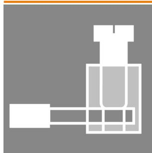
Connecteur débrochable M12 en IP 67 disponible avec raccordement à ressort ou à vis.
