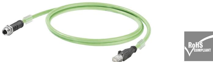
Câbles IE confectionnés pour applications EtherNet/IP avec connecteur débrochable, type M12 X, cat. 6A, selon CEI 61076-2-109 et RJ45 connecteur débrochable pour applications 10 GBit/s
