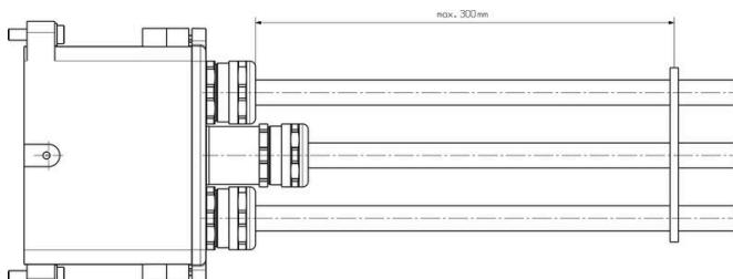
Pour éviter d'endommager les contacts et les douilles isolantes, nous vous recommandons de réparer le câble. Les distances correspondantes sont indiquées dans le dessin ci-après. La fixation du câble n'est pas incluse dans la portée de la livraison.
