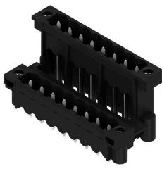
Connecteurs mâles résistants aux hautes températures, à double étage, disposés latéralement, avec bride ou bride à souder. Picot à souder de 1,5 mm valable pour les applications de soudure par refusion. Picots de 3,2 mm adaptés à la soudure à la vague et par refusion. Ils peuvent être repérés et codés.
