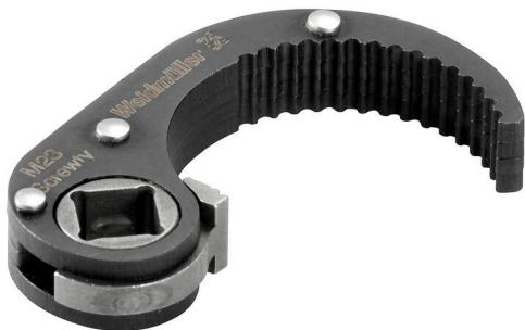
Les accessoires Screwty® sont indiqués pour les connecteurs débrochables ronds M23 à équiper et moulés, avec une dimension extérieure du moletage de  $26,2 \pm 0,3$  mm. Le couple de raccordement est de 2-2,5 Nm.
