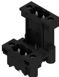
Connecteurs mâles fermés, résistant aux hautes températures, double étage, avec décalage latéral, en option avec brides à souder. Picot de 1,5 mm adapté à la soudure par refusion. Picots de 3,2 mm adaptés à la soudure à la vague et par refusion. Ils peuvent être repérés et codés.
