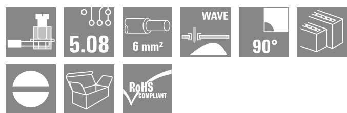
Blocs de jonction bas pour circuit imprimé, mono et multirangée, avec raccordement à étrier éprouvé au pas de 5,00 mm et 5,08 mm, avec sortie de fil à 90°. Section jusqu'à 6,0 mm<sup>2</sup>.
