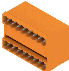
Connecteur mâle avec enfichage parallèle. La longueur des picots est optimisée pour la soudure à la vague. Ils peuvent être repérés et codés.
